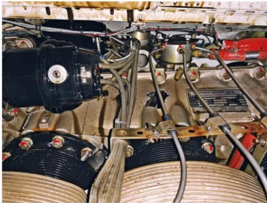
**Alles voll Öl** Durch das Loch im Kurbelgehäuse ist Öl bis oben an die Cowling gespritzt. Mutmaßliche Ursache: Eine Pleuelstange hat den Motorblock durchgeschlagen
